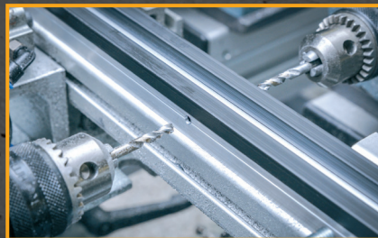
Bohrungen für die Seildurchführungen
